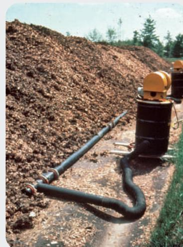
FOTOGRAFÍA 4 y 5: Pilas estáticas con aireación forzada
