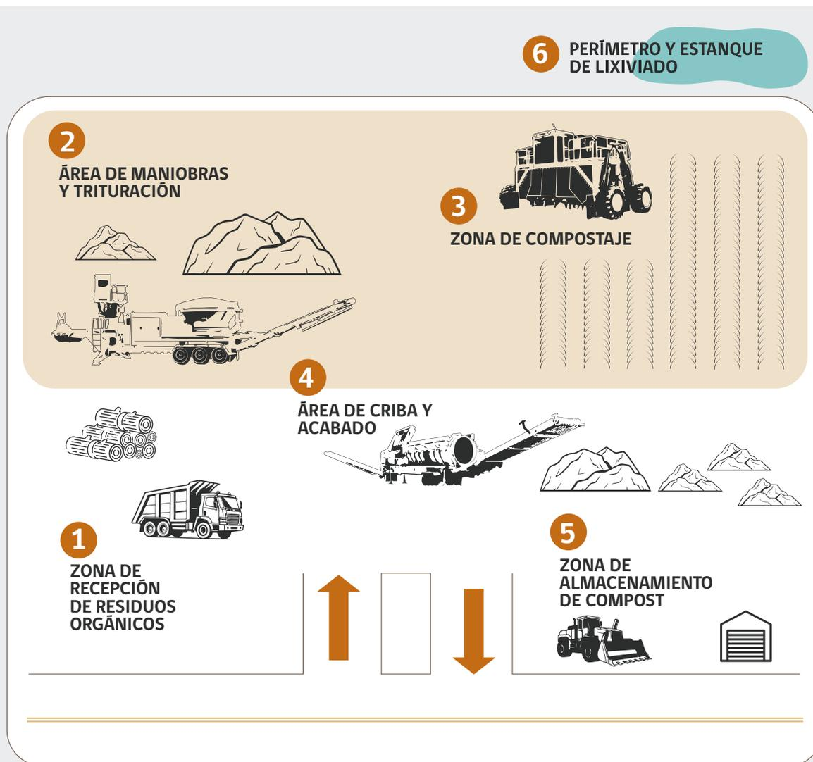
FIGURA 2: Componentes de una planta de compostaje
