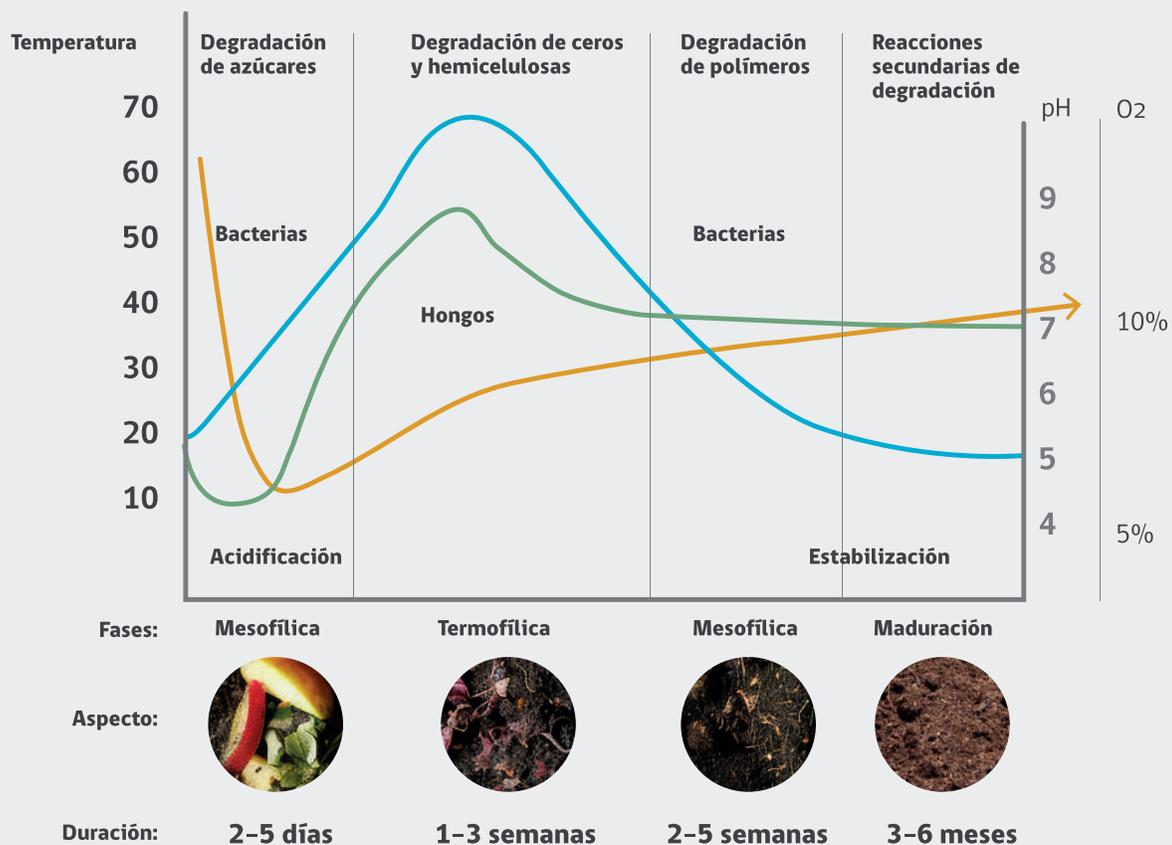
FIGURA 1: Fases térmicas del compostaje
