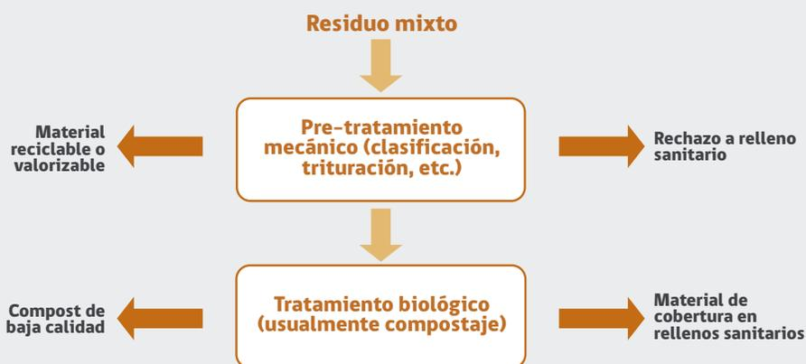
**FIGURA 5: Diagrama de flujo del tratamiento mecánico-biológico**
