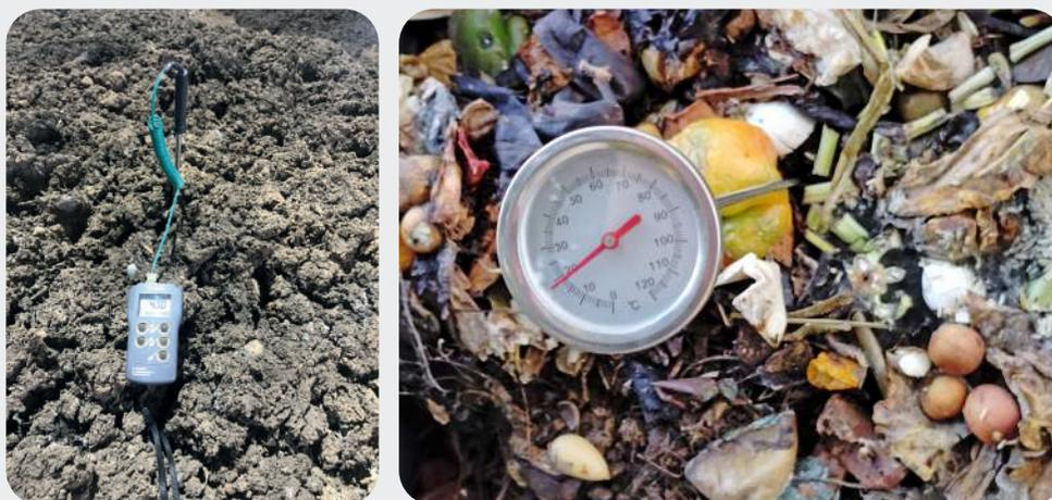
FOTOGRAFÍA 17 y 18: Sensor de temperatura portátil (izquierda) y termómetro análogo (derecha)
