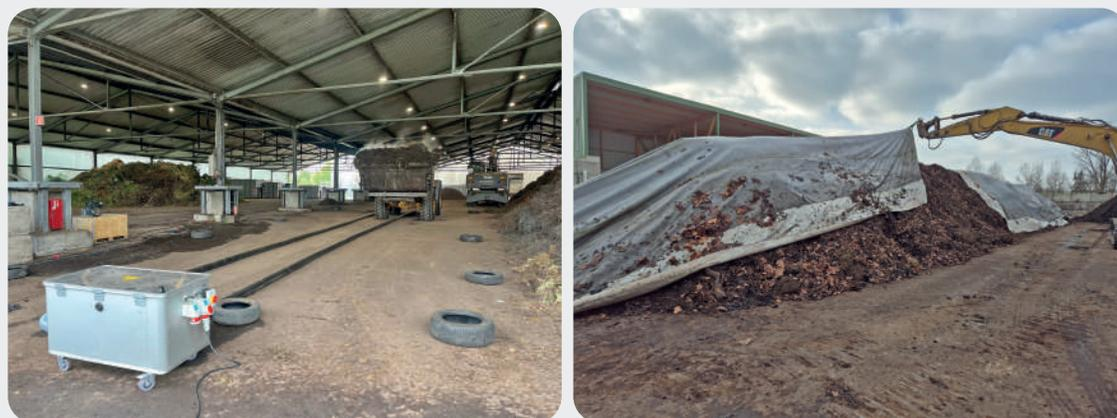
FOTOGRAFÍA 6 y 7: Pilas estáticas con aireación forzada y cubierta semipermeable
