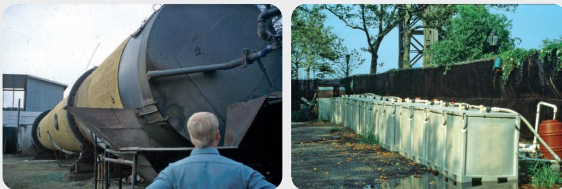
FOTOGRAFÍA 9 y 10: Reactor giratorio a escala industrial (izquierda) y Contenedores modulares aireados (derecha)
