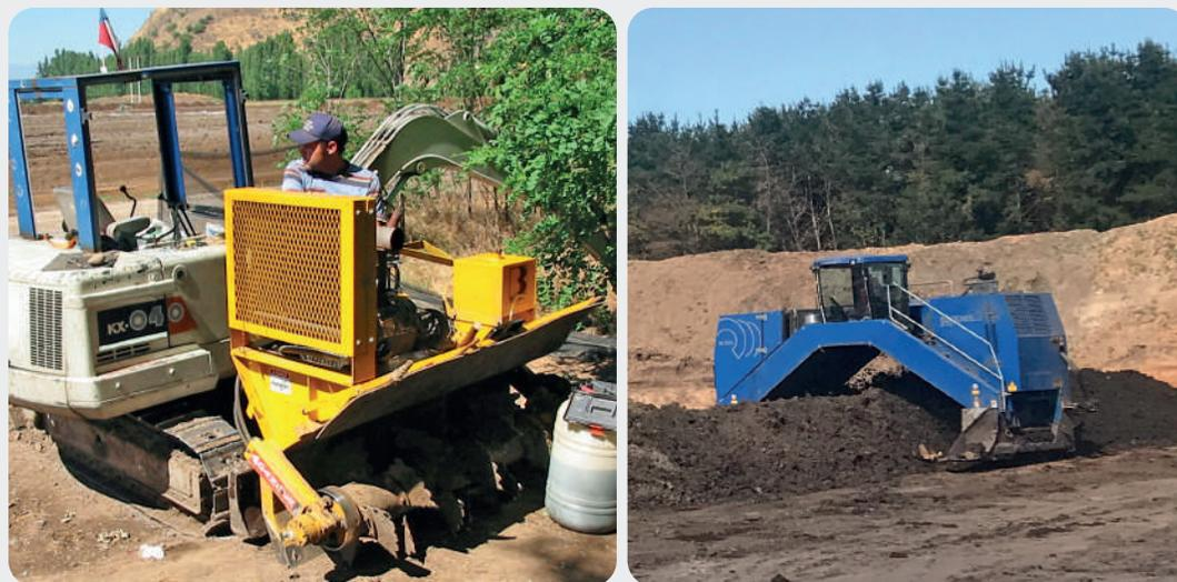
FOTOGRAFÍA 2 y 3: Volteadora pequeña (izquierda) y Volteadora autopropulsada (derecha)
