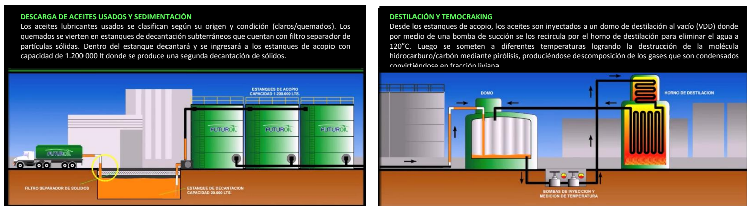
Figura 43. Proceso Productivo de RE-refinación FUTUROIL
