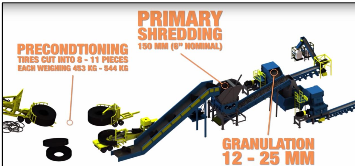
Figura 38. Planta de Valorización de NFU para transformación en gránulo y polvo
