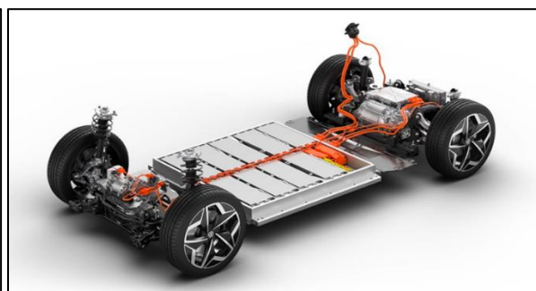
Figura 14. Diagrama general de la disposición de los módulos de baterías de ion litio en un vehículo eléctrico.
