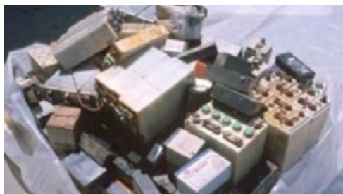
Colocación inadecuada de BPAU sobre una tarima
