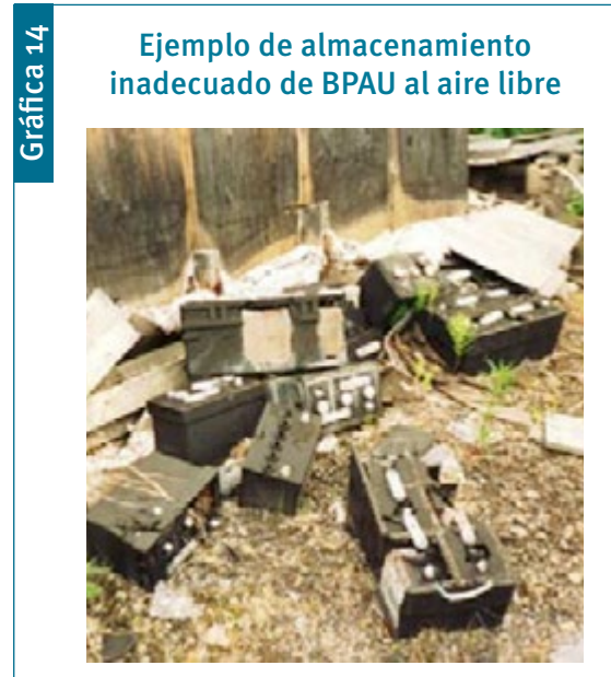
Fuente: Gretchen Krum, "Battery stacking" [Apilamiento de baterías], comunicación por correo electrónico con la autora el 22 de julio de 2014.
