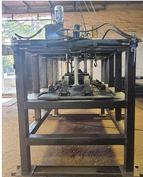
2. **Delaminación:** proceso mecánico que separa la lámina de vidrio templado de la celda solar encapsulada en goma Eva.
