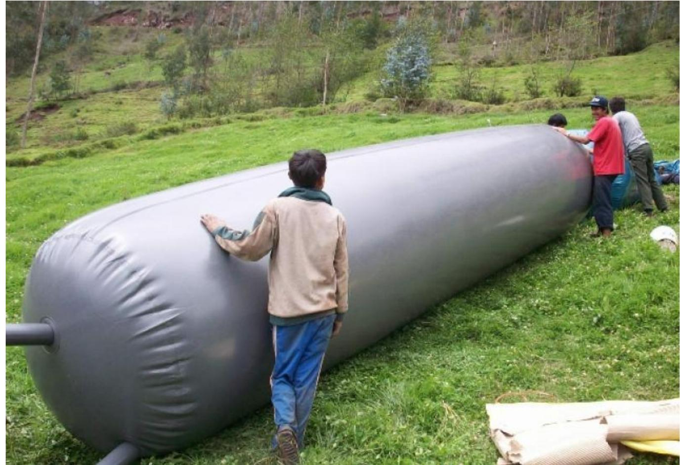
**Biodigestor de estructura flexible**
