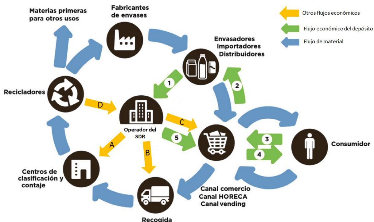
Figura 2.4. Diferentes flujos dentro de un SDR. Fuente: Agencia de Residuos de Cataluña y elaboración propia.
